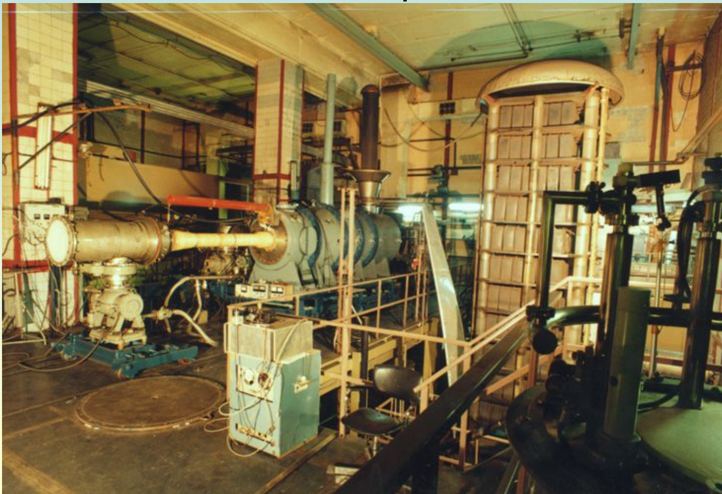
Вакуумная камера 3*15 м с возможностью криоэксперимента
