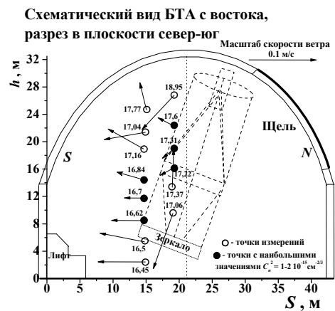
Рис. 8. Измерения на кран-балке вертикальных профилей полей температуры и скорости воздушных потоков в БТА. 04.08.2016
