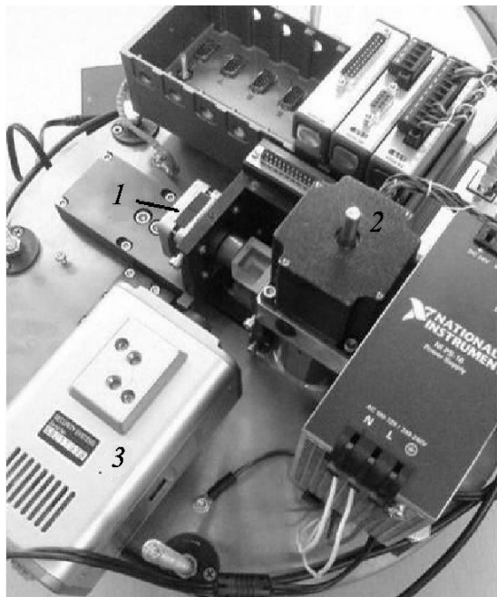
Рис. 6. Общий вид подвесной части спектрографа. Обозначения: (1) привод одной из пластин автогида; (2) универсальный привод поляриметрического блока; (3) ТВ-камера.
